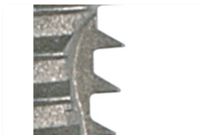
Obr. 4 Charakteristický typ závitů BTLock Tite One implantátu, které jsou obráceny k apexu těla fixtury
